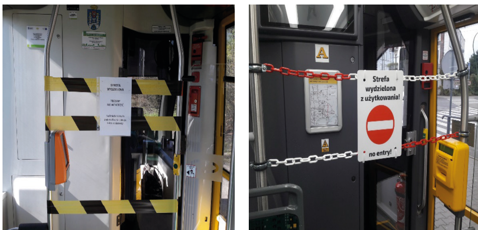
Rysunek 1. Wygradzenia kabin motorniczych w tramwajach niskopodłogowych, w wersji tymczasowej (z lewej, 15 marca 2020 roku) i trwałej (z prawej, 22 listopada 2020 roku)
