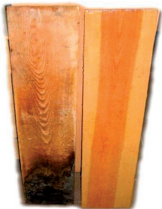
Рис. 1. Лак огнезащитный ЛДО-11 до и после испытаний по ГОСТ 30244
