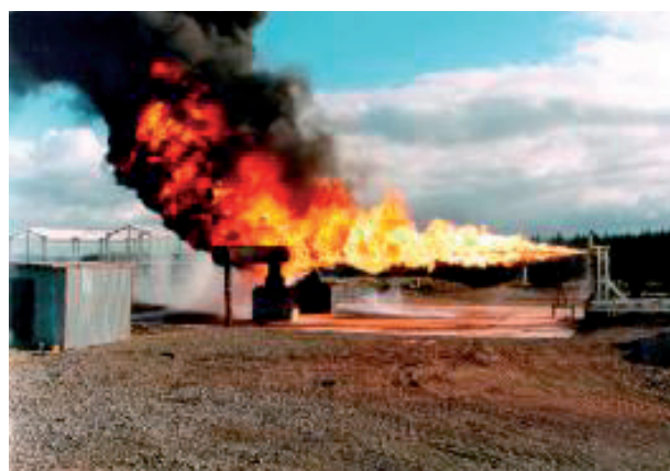
Fot. 3. Pożar strumieniowy. [16] Pict. 3. An example of jet fire. [16]
