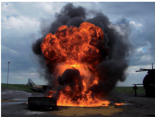
Fot. 8. Wykypienie ropy naftowej. [23] Pict. 8. An example of BOILOVER. [23]
