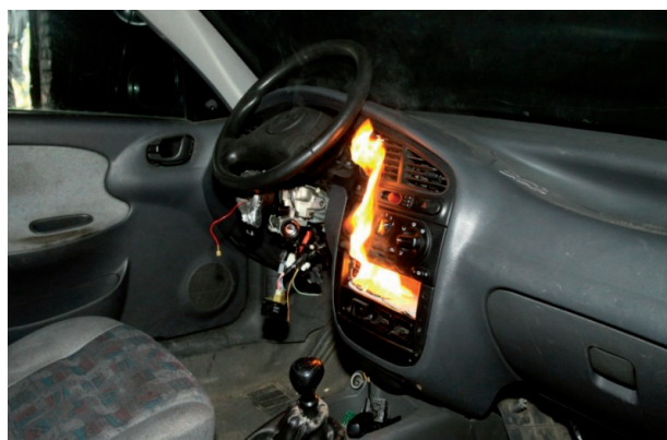
Ryc. 4. Miejsce zainicjowania pożaru. Fig.4. The place of the fire initiating.
