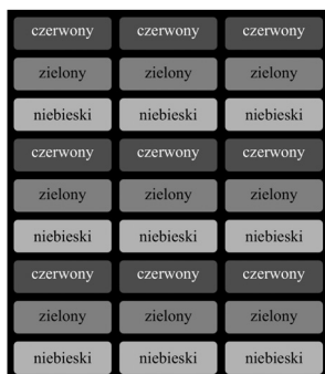
Rysunek 1. Sposób ułożenia pikseli w monitorach LCD
