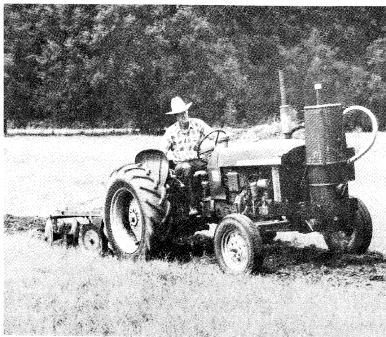
Rys. 1-1. Generator gazu drzewnego podczas pracy w polu będącej częścią testów.
