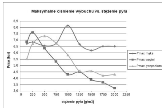
Ryc. 8. Zależność maksymalnego ciśnienia wybuchu od stężenia pyłu dla 3 wybranych mieszanin pyłowo-powietrznych, uzyskane podczas pomiarów na stanowisku badawczym wg PN-EN 14034 w CNBOP-PIB.
