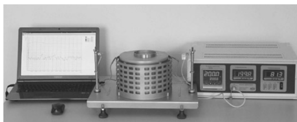
Ryc. 6. Stanowisko badawcze do pomiarów minimalnej temperatury zapłonu warstwy pyłów wg PN-EN 50281-2-1 w CNBOP-PIB.
