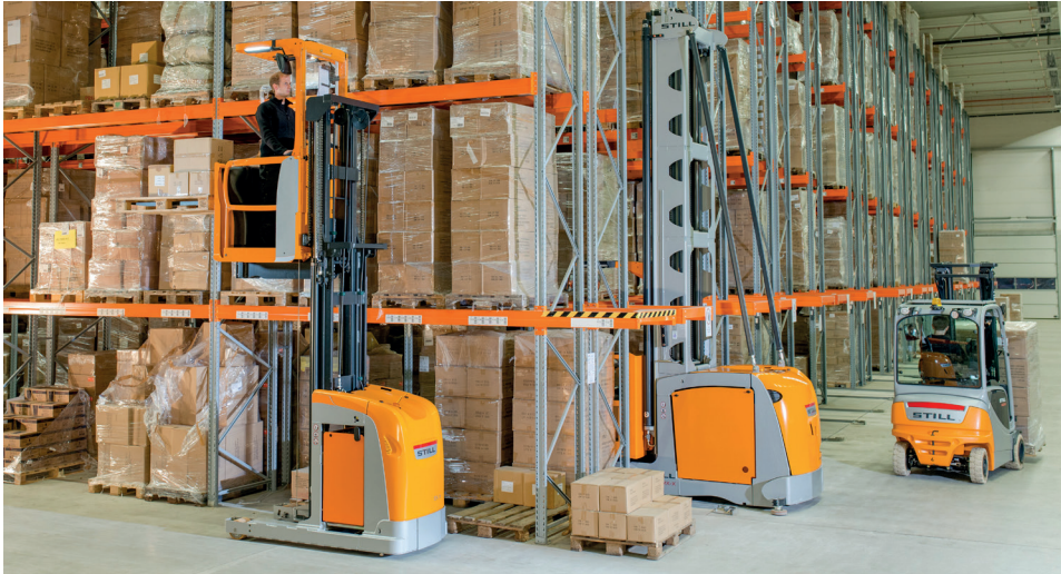
Rysunek 7.3. Wózek podnośnikowy, z operatorem podnoszonym wraz z ładunkiem
